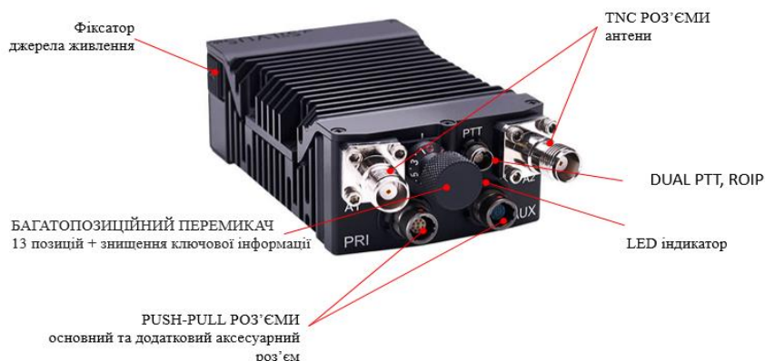
Рис. 3.3. Види роз'ємів на радіостанції
